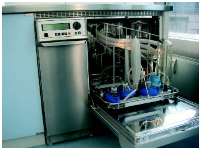
■ In medizinischen Einrichtungen wird Wasser in vielfältiger Weise verwendet, hier z. B. im Reinigungsautomaten einer OP-Abteilung zur Aufbereitung von Narkoseinstrumentarium.
